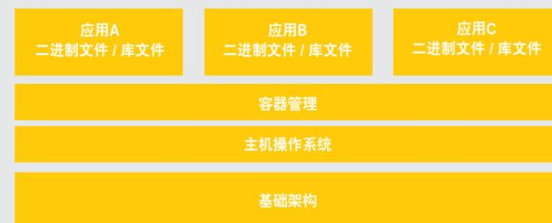
图2：利用LXC容器实现轻量级虚拟化
