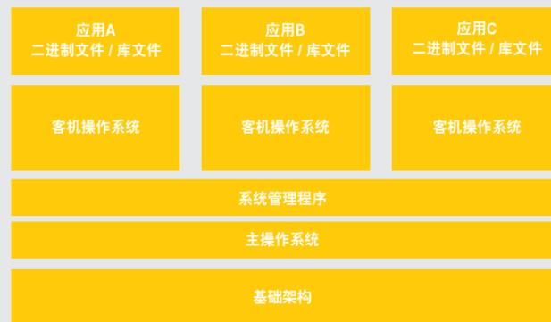
图1：利用虚拟机(VMs)实现的传统虚拟化
